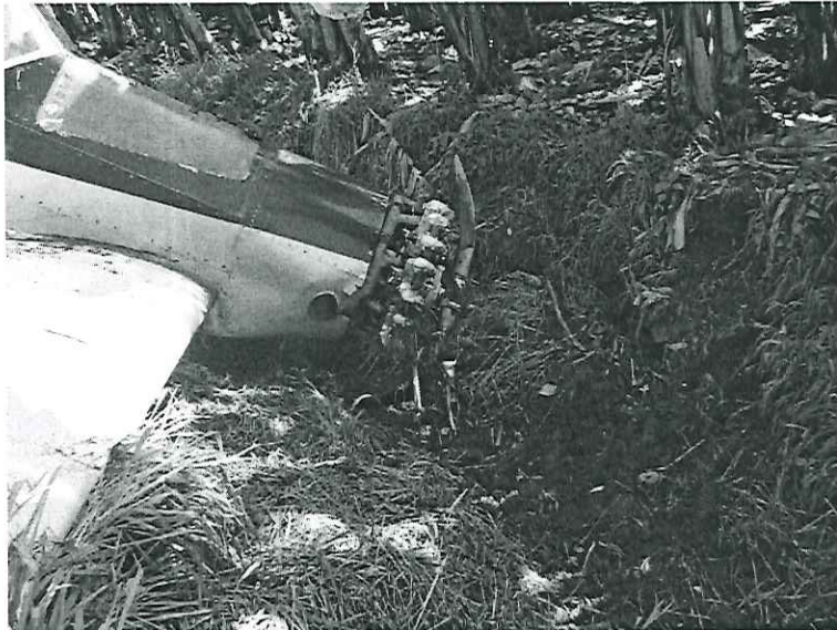
Ilustración 7 Daño en la hélice
